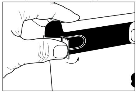
4. Connectez le câble de données au scanner 3D iSense et à l'iPad.
